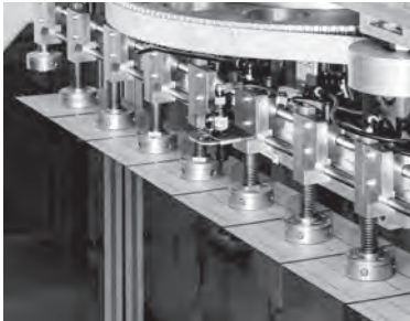
Le stringhe vengono testate e allineate...
