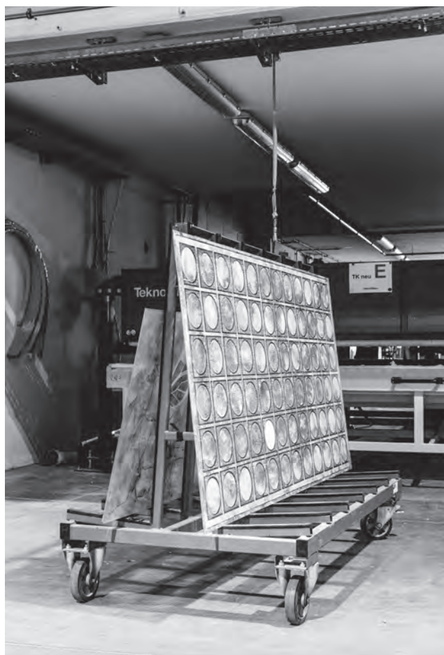
Il vetro del modulo UAE dopo il trattamento in forno e prima della pulitura.
